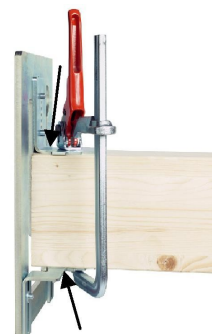
Obr. 24 Upevnění šablony čepu pomocí svěrky na kolmo uříznutý trám.
