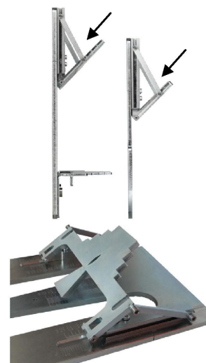
Obr. 23 Naklápěcí dorazy na šabloně čepu a dlabu.
