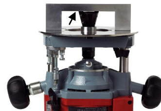
Obr. 17 Výška frézy nastavená podle měrky
