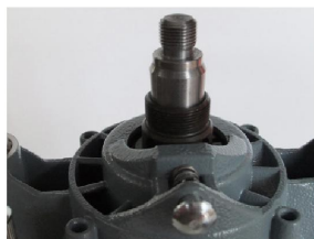
Obr. 15 Namontovaný kónický adaptér M12x1
