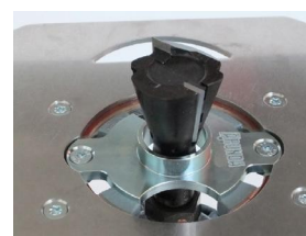
Obr. 13 Namontovaná deska, kroužek a fréza
