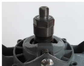
Obr. 16 Kónický adaptér M12x1 s utaženou maticí
